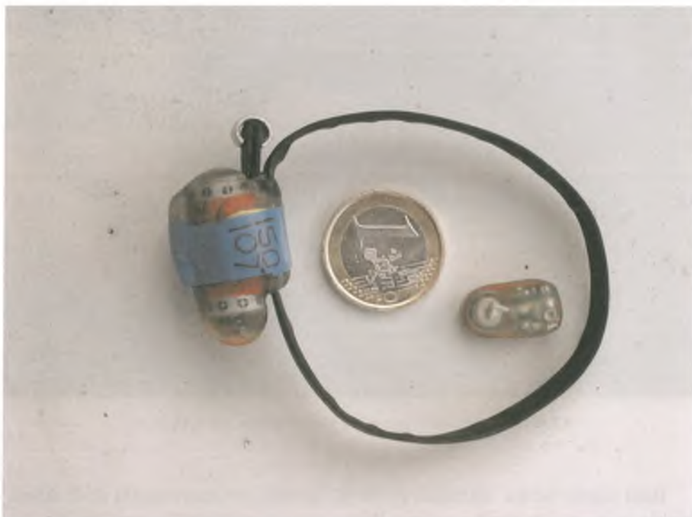
4.1. irudia: Ikerlan honetan erabilitako bi transmisore-motak. Txikiena subkutaneoki ezartzekoa da eta handiena lepoan zintzilik jartzekoa. Euro bateko txanpona jarri da erdian, transmisoreen tamainaren erreferentzi moduan. Transmisore bakoitza irrati-seinalea frekuentzia propio batean igortzeko dator prestatua; argazkiko transmisore handienaren kasuan, beraren frekuentzia adierazten duen etiketa ikus daiteke (150.107 MHz.). Arg.: I. Irizar.
